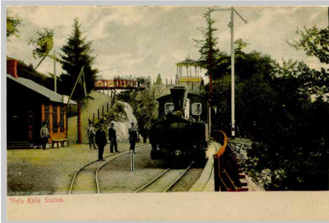
Vista Kulle Station. Obegagnat vykort från omkring 1910. Gripenbergsbanan – systerbana till Jönköping-Vaggeryd – var en smalspårig svensk järnväg med 600 millimeter spårvidd som förband orterna Jönköping och Vireda. Järnvägen öppnades sommaren 1894 och lades ned 1935.
